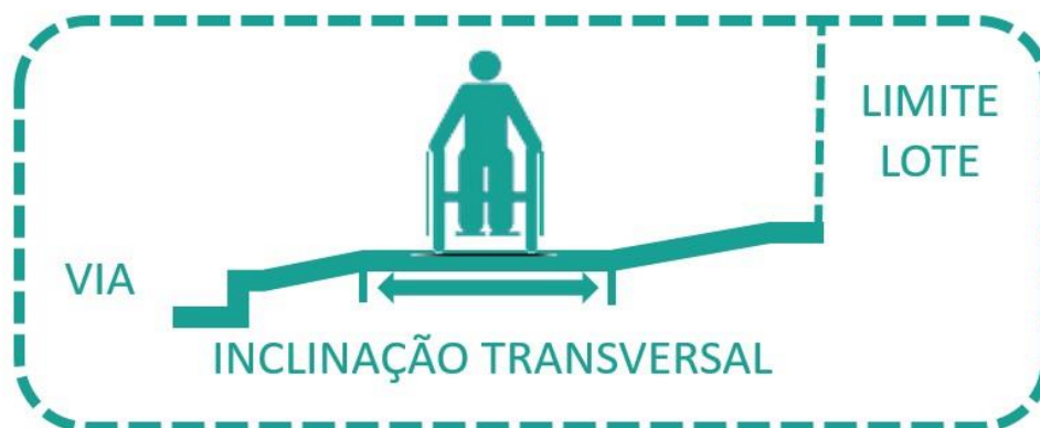
Figura 8: inclinação transversal de calçadas
